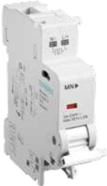
Расцепитель нулевого напряжения TGB1N-MN (для корпуса 63) (далее именуемый как расцепитель), в основном, используется в сети переменного тока 50/60 Гц с номинальным напряжением 230 В и состоит из автоматического выключателя серии TGB1N с током корпуса 63А и автоматического выключателя остаточного тока с током корпуса 63А (32А) для защиты от понижения напряжения.
