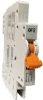
Вспомогательный контакт TGB3-OF2 используется в линии переменного тока 50/60 Гц с заданным тепловым током до 6А, с номинальным напряжением до 415 В или номинальным напряжением постоянного тока до 130 В и в основном состоит из автоматического выключателя серии TGB3 с током корпуса 125А и автоматического выключателя остаточного тока с током корпуса 63А для дистанционной индикации сигнала включения/выключения автоматического выключателя.
